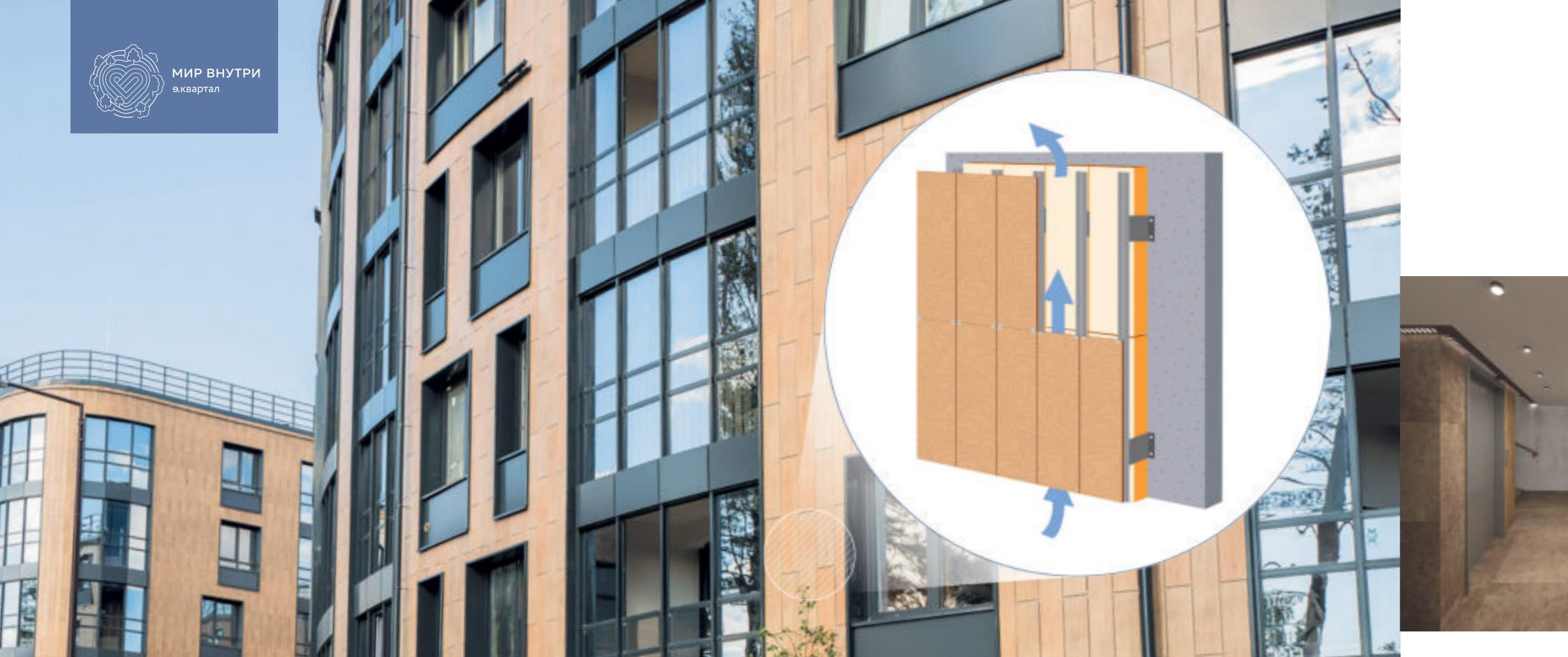
Наши дома строятся по монолитной технологии, а вентилируемые фасады позволяют монолиту «дышать». Это обеспечивает зданиям отличную теплоизоляцию и долговечность. Благодаря пространству между стеной и облицовкой повышается устойчивость строения к атмосферным явлениям,
